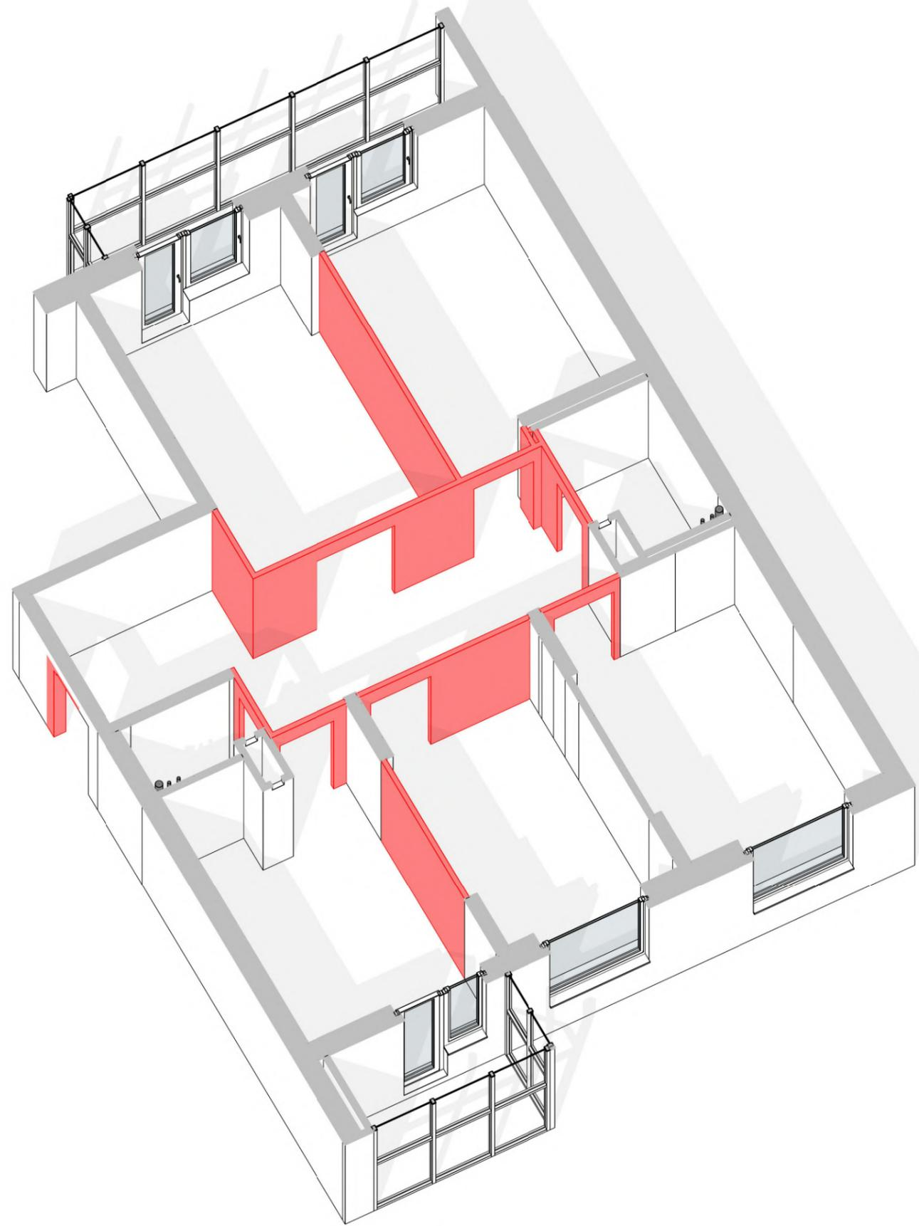
**Ведомость демонтажа стен.**
