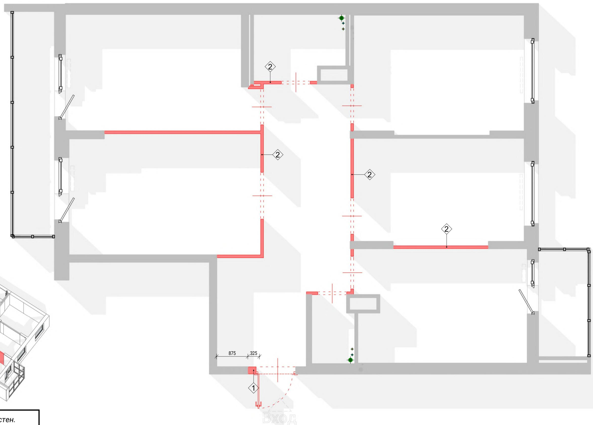
Ведомость демонтажа стен.
